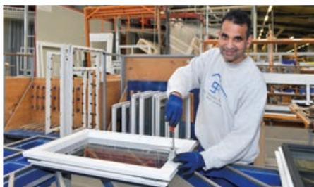
Einbruchhemmende Fenster und Türen werden bei der Alpsteg Fenster AG massgeformt gefertigt und auf RC2-Norm geprüft.
